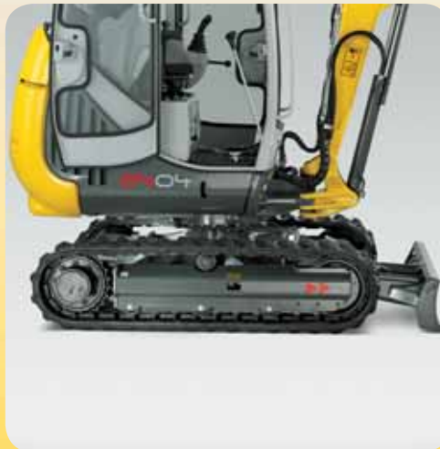
Das extrem lange und breite Fahrwerk gibt auch auf schwierigem Terrain volle Sicherheit. Die Agilität und die Kraft des Baggers können immer voll genutzt werden.
