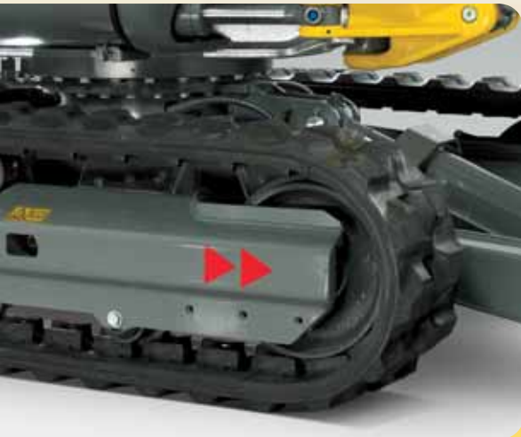
Das selbstreinigende Laufwerk entledigt sich der Verschmutzungen schon während der Bewegung.
